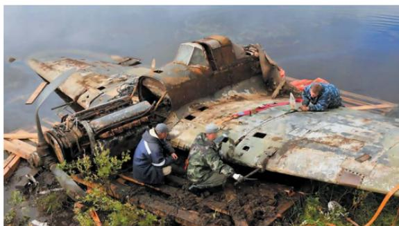
Холодная вода, отсутствие кислорода и частично заиленный корпус самолета позволили сохраниться машине в достаточно хорошем состоянии. Правда, деревянную хвостовую часть самолета пришлось делать заново. Всего же работы от поиска самолета до реставрации и летных испытаний заняли более пяти лет.
